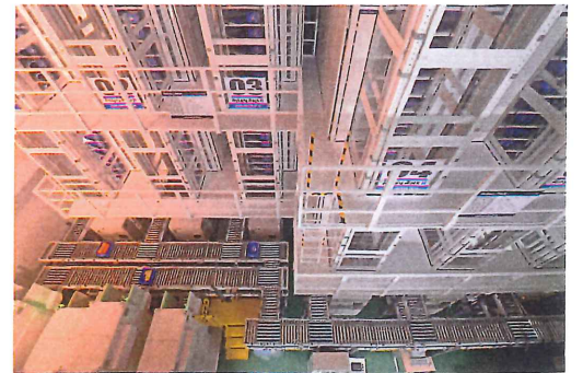
垂直方向のコンベア（つまりリフト）と水平方向のコンベアで、必要な樹脂製コンテナが必要な場所へと移送する。自動入庫装置（レトリバー）は合計14基。コンベアの総延長はこのロータリーラックだけで500mになる。高さ14m、縦×横は17m。床部分は3階であり、入庫は1階で行なう。
